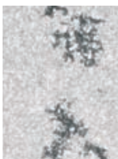
Exempel på porositet på grund av felaktig dosering av cobolt.
